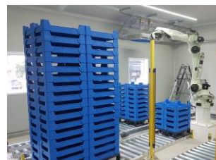
Kawasaki CX210L bij Schanekamp kratten met meelwormen hanteren
