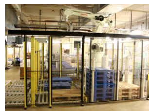
Kawasaki ZD130S bij Cargill Berlin voor dozen van 3 verpakkingslijnen
