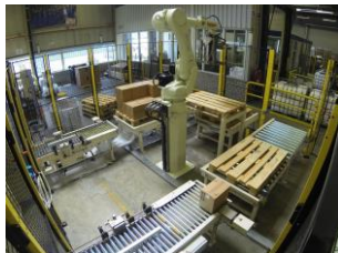
Kawasaki RD080N bij PPG Coatings dozen met verf van 2 vullijnen
