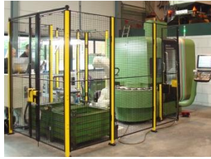
Kawasaki RS020N met RFA-Vision en Bin-Picking bij DMG CTV160
