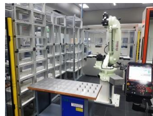
Kawasaki CX210L met RFA-Pallet palletbelading Mazak VTC800-SR20
