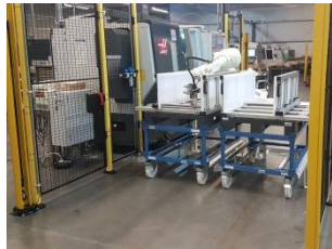
Kawasaki RS020N met rolmagazijnen bij Haas draaibank
