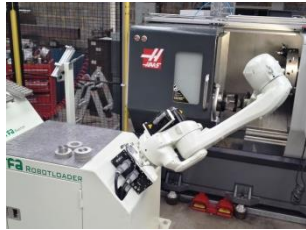
Kawasaki RS020N met RFA-Raster bij Haas draaibank
