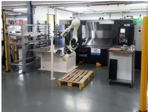
Kawasaki RS020N met RFA-Pallet bij Doosan Puma draaibank
