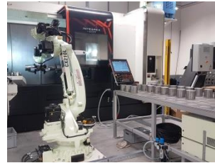
Kawasaki CX210L met RFA-Raster bij Mazak Integrex
