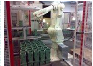
Kawasaki FS030L met RFA-Vision bij Hermle C800U freesmachine
