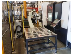
Kawasaki BX200L met RFA-Raster bij Mazak Integrex
