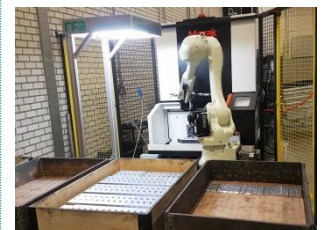
Kawasaki RS020N met RFA-Vision bij Mazak freesmachine
