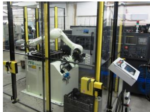
Kawasaki RS010N met RFA-Raster bij Hwacheon draaibank
