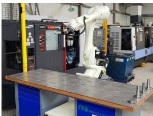
Kawasaki RS020N met RFA-Raster bij Samsung Smec draaibank
