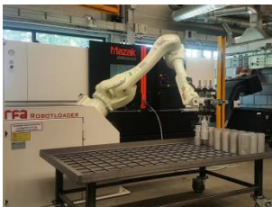
Kawasaki RS020N met RFA-Raster bij Mazak Quickturn draaibank
