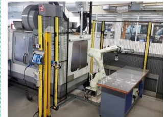
Kawasaki RS020N met RFA-Raster bij Haas VF3 freesmachine
