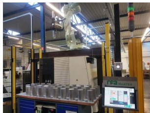
Kawasaki RS080N met RFA-Raster boven een DMG CTX 510 draaibank
