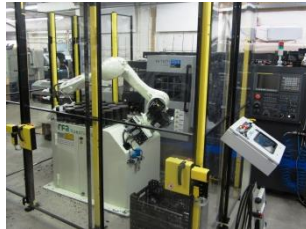
Kawasaki RS010N met RFA-Raster bij Hwacheon draaibank
