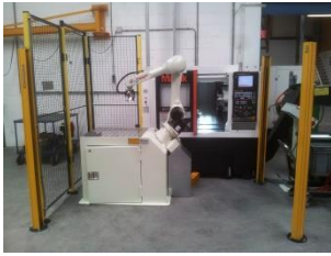
Kawasaki RS010N met RFA-Raster bij Mazak Quickturn Smart draaibank
