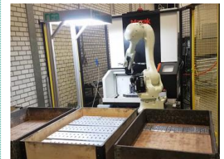
Kawasaki RS020N met RFA-Vision bij Mazak freesmachine
