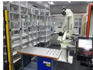
Kawasaki CX210L met RFA-Pallet palletbelading Mazak VTC800-SR20
