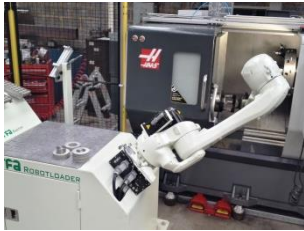
Kawasaki RS020N met RFA-Raster bij Haas draaibank
