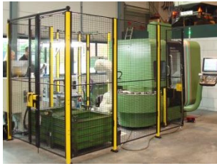
Kawasaki RS020N met RFA-Vision en Bin-Picking bij DMG CTV160
