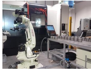
Kawasaki CX210L met RFA-Raster bij Mazak Integrex
