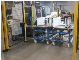
Kawasaki RS020N met rolmagazijnen bij Haas draaibank
