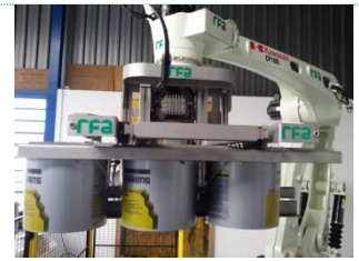
Kawasaki CP180L bij Akzo Nobel (B) emmers met verf palletiseren
