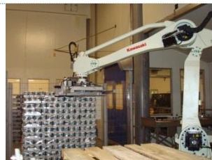
Kawasaki ZD130S bij Ouwehand trays met glazen potten palletiseren
