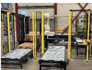
Kawasaki RD080N bij Bijlard dozen met kitten en lijmen palletiseren
