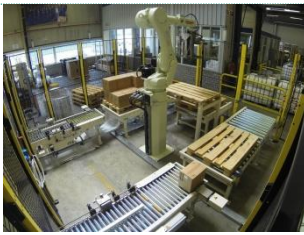
Kawasaki RD080N bij PPG Coatings dozen met verf van 2 vullijnen
