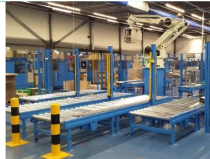
Kawasaki ZD130S bij ITS Foil & Film dozen van 2 lijnen palletiseren
