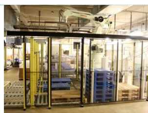
Kawasaki ZD130S bij Cargill Berlin voor dozen van 3 verpakkingslijnen
