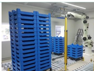
Kawasaki CX210L bij Schanekamp kratten met meelwormen hanteren
