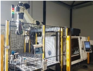
Kawasaki BT200L met RFA-Raster bij DMG Mori CLX 550 draaibank
