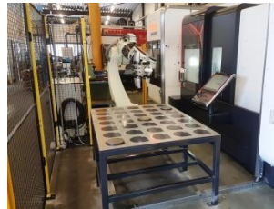
Kawasaki BX200L met RFA-Raster bij Mazak Integrex
