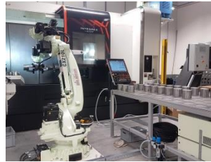
Kawasaki CX210L met RFA-Raster bij Mazak Integrex
