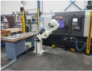
Kawasaki RS020N met RFA-Raster bij Doosan Puma draaibank
