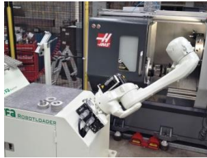
Kawasaki RS020N met RFA-Raster bij Haas draaibank
