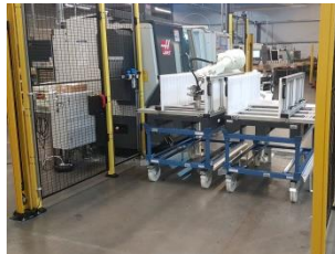
Kawasaki RS020N met rolmagazijnen bij Haas draaibank
