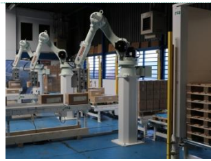
Systeem met 3x Kawasaki RD080N bij Barry Callebaut (B) dozen van 3 lijnen
