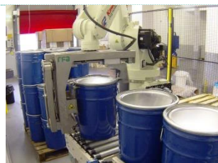
Kawasaki RD080N bij Cargill-ZOR voor emmers en vaten met cacao
