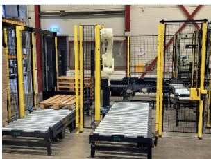
Kawasaki RD080N bij Bijlard dozen met kitten en lijnen palletiseren
