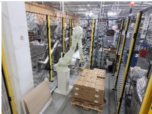
Kawasaki RS020N bij Havo B.V. dozen met klei palletiseren
